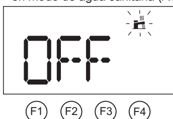
Fig.41 Desactivación del funcionamiento en modo de agua sanitaria (ACS)
